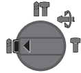
Положення для свердлення без удару в деревині, металі, кераміці і пластмасі, а також для закручування гвинтів
