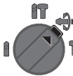
Läge Vario-Lock för inställning av mejselläget I detta läge snäpper inte slag-/vridstoppomkopplaren 13 fast.
